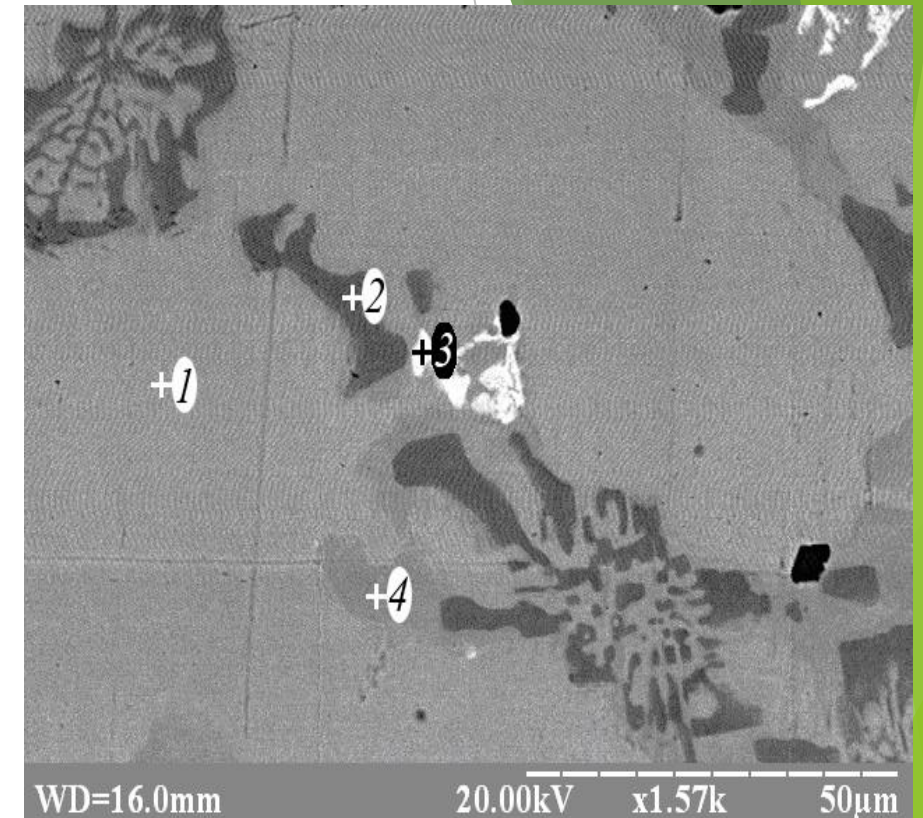
Рисунок 6 – Локальний аналіз фазових елементів самофлюсивного сплаву
