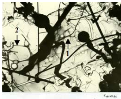
Рис. Микроструктура промежуточного подслоя корундового покрытия на этилсиликатной связке: 1-остатки остова кремнеземистого кластера, 2-глобулы наночастиц \beta -SiC
