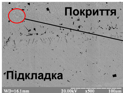
Перехідна зона підкладка-покриття
