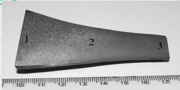
Рисунок 1 - Макрошліф поздовжного перетину зразка сплаву VT22, отриманого при зупинці крокового кування - прокатки прутка під деталь кріплення
